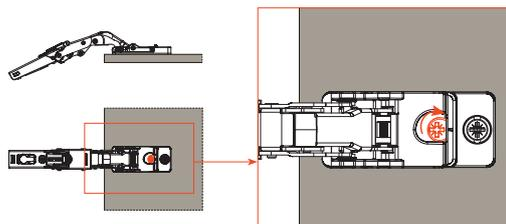
3. Для завершения установки, отцентрируйте петлю относительно монтажной планки и зафиксируйте поворотом эксцентрикового винта.
