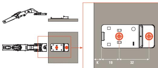
1. Монтажная планка устанавливается на фасад с помощью винтов входящих в комплект
